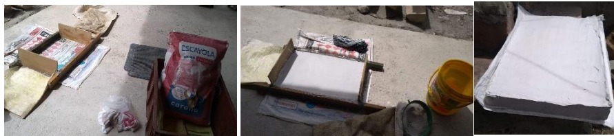
Figura 41 Fabricación de Placa y Moldes de Yeso
