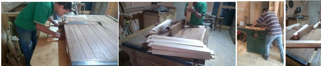
Figura 39 Perforaciones, Espigas y Escoplos.
