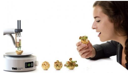
Figura 11 Muestra del sistema de impresión 3D, para la creación del elemento comestible. (Rutzerveld, 2018)
