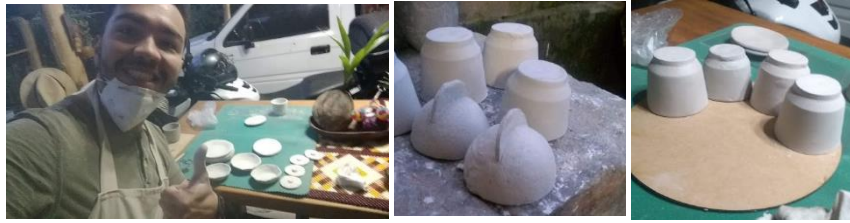
Figura 43 Proceso de Lijado y Pulido de Piezas
