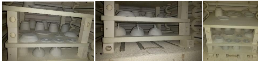
Figura 44 Proceso de Cocción de Piezas de Bizcocho
