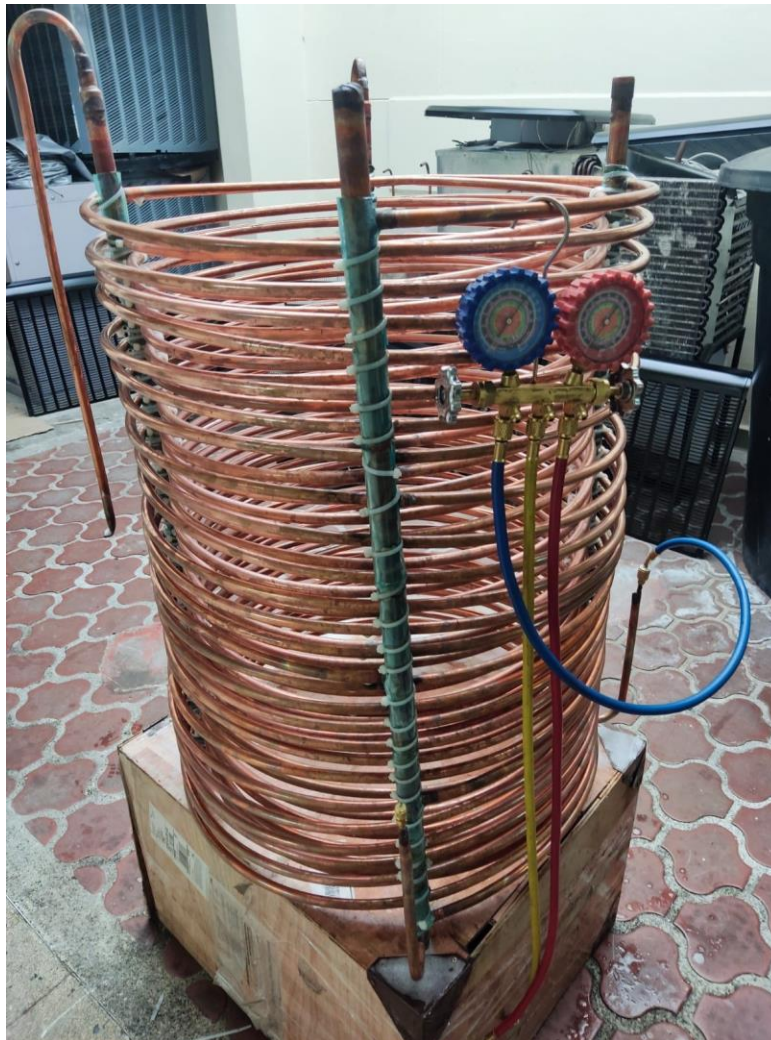
Ilustración 9: Intercambiador de calor de cobre por convección natural. Fuente propia
