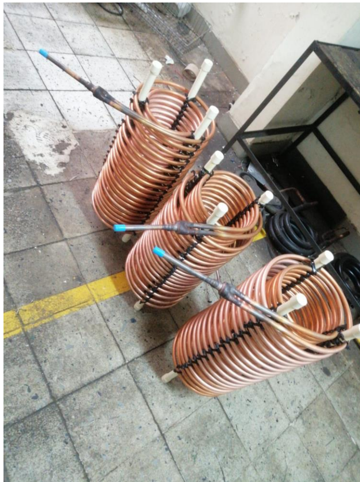
Ilustración 10: Intercambiadores de calor de cobre por convección natural Fuente propia
