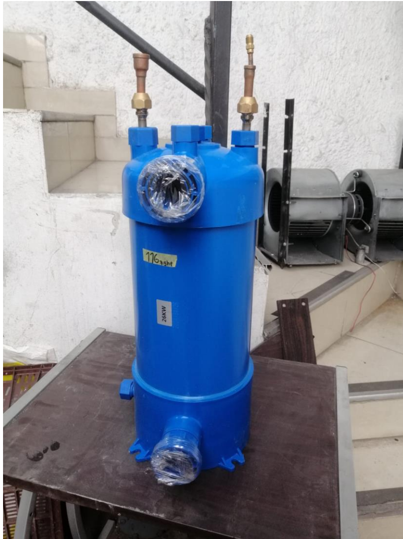
Ilustración 12: Intercambiador de calor de titanio Fuente propia
