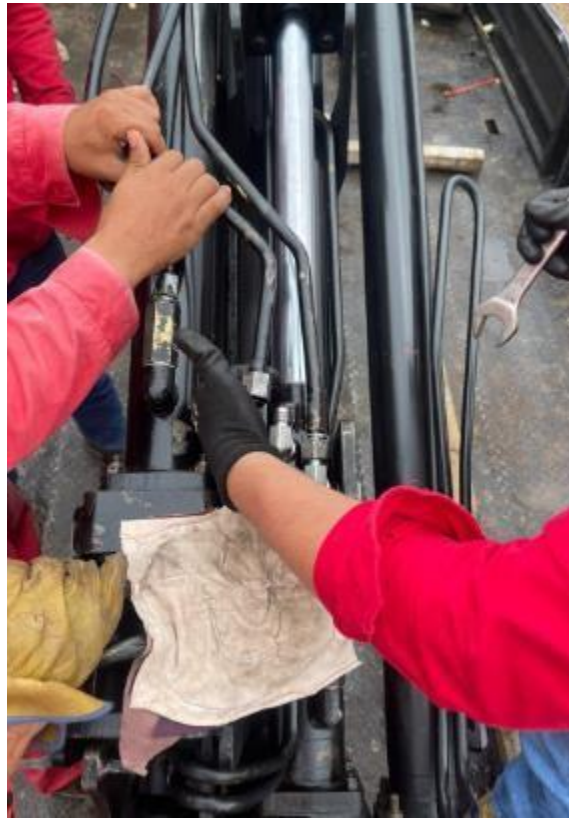
Figura 13. Cambio de racor de brazo articulado camión grúa Global Tech.
